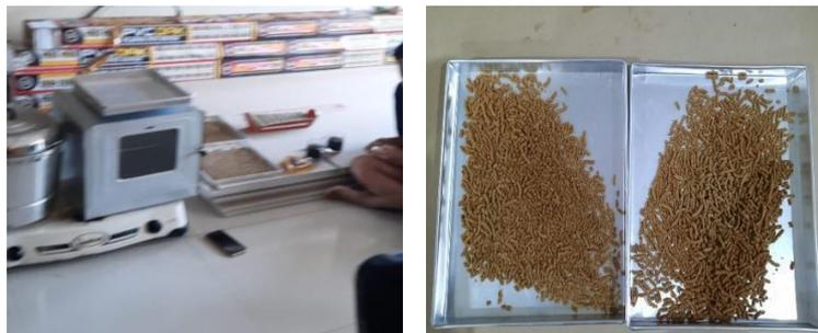
Gambar 11. Pengovenan Pelet Ikan. Pelet Dimasukkan Kedalam Oven untuk Mengurangi Kadar Air (Kiri). Hasil Pelet Ikan Setelah Dikeringkan di Oven (Kanan)
